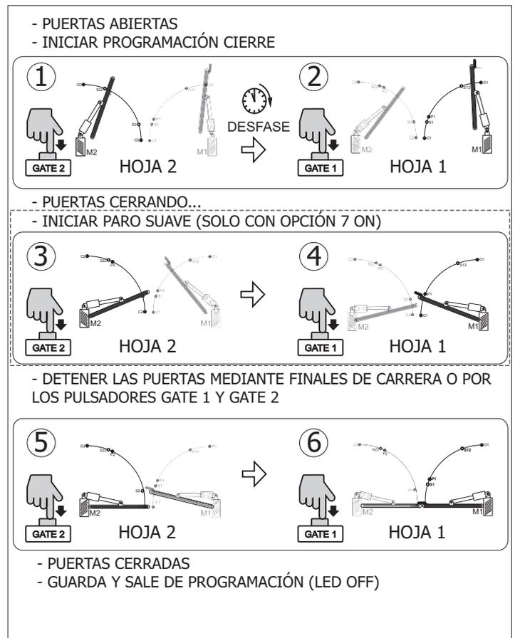
EN CASO DE UTILIZAR UN MOTOR, REALIZAR LA PROGRAMACIÓN SOLO CON EL PULSADOR GATE 1.
